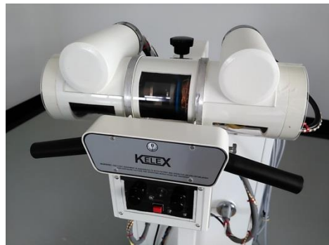
เปลือกหุ้มที่ฝาให้เห็นหลอดรังสีเอกซ์ภายใน
