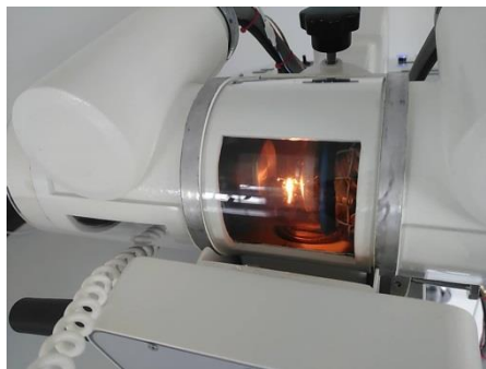
หลอดรังสีเอกซ์ขณะเริ่มจุดไส้หลอด
