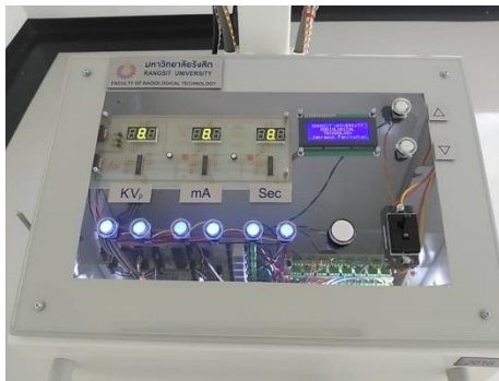
แผงควบคุมเครื่อง
