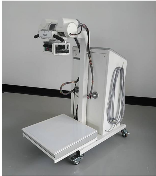
เครื่องกำเนิดรังสีเอกซ์เสมือนจริง พร้อมระบบหยุดการหมุนของโรเตตติ้งแอนโนด
